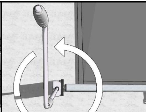
Wir drehen die Kurbel, um die Abdeckung aufzurollen. In diesem Fall (die Kurbel auf der linken Seite der Wickelwelle) müssen wir nach links drehen. In ähnlicher Weise drehen wir uns, während wir auf der rechten Seite des Rollenrohrs stehen, nach rechts.
