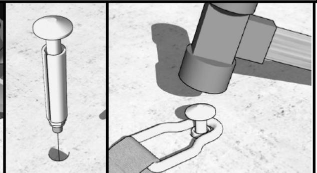
Im Abstand von ca. **35-60 cm** (Standard) von die Abdeckung Löcher für die Befestigungsschrauben mit einem  $\varnothing$  10 mm Bohrer bohren.
